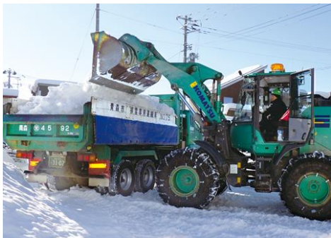
＜除雪作業の様子＞
